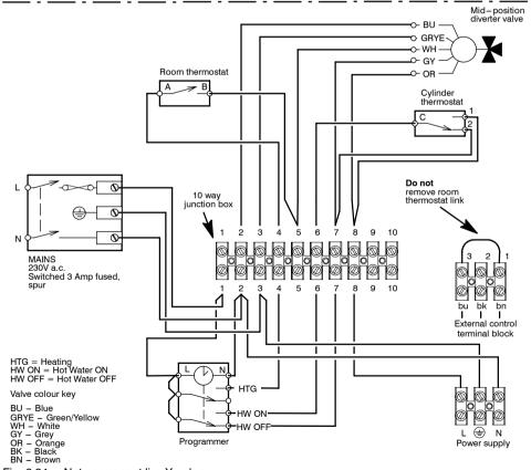
Fig. 6.24 - Not permanent live Y-plan
